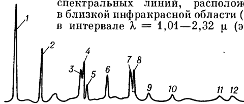
Рис. 1. Инфракрасный спектр излучения ртути. Длины волн в \mu : 1—1,014; 2—1,129; 3—1,357; 4—1,367; 5—1,395; 6—1,530; 7—1,692 и 1,694; 8—1,707 и 1,711; 9—1,814; 10—1,970; 11—2,249; 12—2,326.
