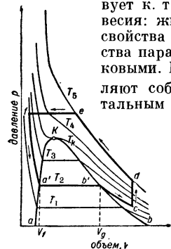
Рис. 1. Равновесие жидкость — пар в однокомпонентной системе. Пограничная кривая aKb разделяет области двух- и однофазного состояния системы. К — критическая точка; T 1 , T 2 , T 3 ... — изотермы. В двухфазной области изотермы совпадают с изобарами.
