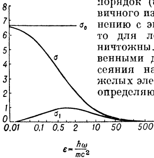
Рис. 2. Зависимость полного эффективного сечения комптоновского рассеяния от энергии первичного излучения \varepsilon : \sigma — эффективное сечение для числа рассеянных фотонов; \sigma_1 — эффективное сечение для энергии, отдаваемой электроном, \sigma_0^2 = 8\pi r_e^2/3 . Эффективные сечения в единицах 10^{-25} \text{ см}^2 на электрон.
