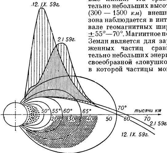
Рис. 9. Распределение поясов радиации по результатам измерений первой и второй советских космических ракет. Вертикальные линии, опирающиеся на траектории ракет, показывают относительную интенсивность радиации.
